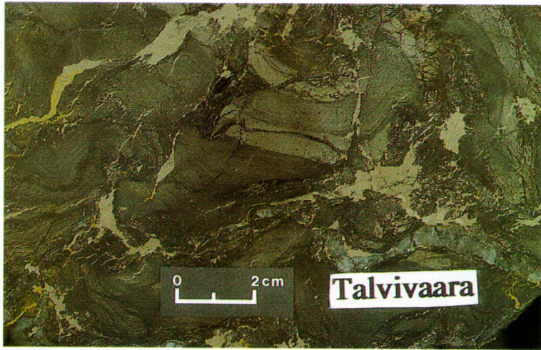
Fig. 3. Metalliferous black shale from the Talvivaara prospect (Figs. 2,4). Photo: Jari Väättäin.
