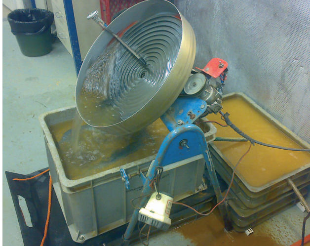
Kuva 6. Spiraalirikastin eli ns. "kultakoir", tällä laitteella raskasmineraalit erotettiin keveämmästä moreeni- ja rapakallioaineksesta. Kuva: Jorma Valkama.
