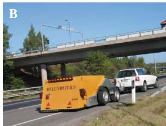
Kuva 4. Liikkuvat laboratoriot, a) Helsingin ammattikorkeakoulun Stadian autolaboratorio (Nuuski-ja), joka soveltuu katupölytutkimuksiin ja b) TKK:n autolaboratorio, joka soveltuu melututkimuksiin (Kuva: Panu Sainio).
