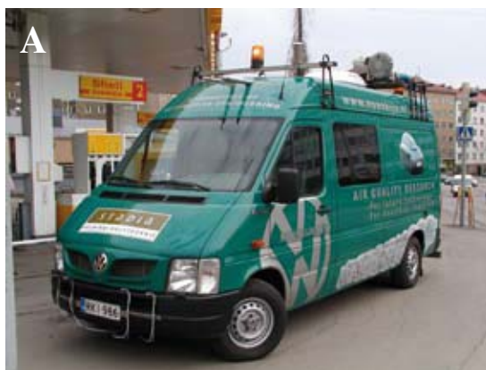
Kuva 4. Liikkuvat laboratoriot, a) Helsingin ammattikorkeakoulun Stadian autolaboratorio (Nuuski-ja), joka soveltuu katupölytutkimuksiin ja b) TKK:n autolaboratorio, joka soveltuu melututkimuksiin (Kuva: Panu Sainio).
