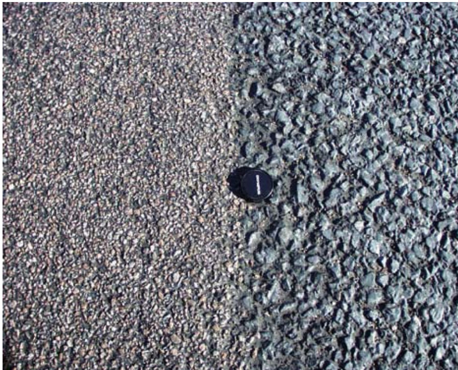
Kuva 3. Hiljaisen asfaltin (vasemmalla) ja SMA16 asfaltin pinnan rakenne. Mitakaava 45 mm. Surface textures of low-noise (on the left) and SMA 16 asphalt pavements. Scale 45 mm.
