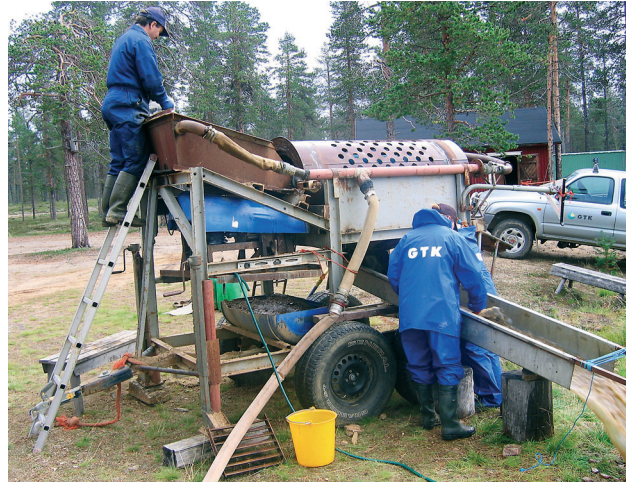
Kuva 9. Raskasmineraalinäytteiden rikastus rumpuseulalla ja rännillä. Kuva Eelis Pulkkinen.
