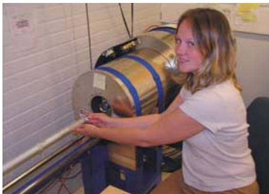
Kuva 1. (a) Jatko-opiskelija Tiiu Elbra mittaamassa Ghanan Bosumtwi-meteoritikkraatterin näytteitä uudella suprajohtavalla SQUID-magnetometrillä. (b) Assistentti Fabio Donadini esittelee opiskelijoille kiinteän maan geofysiikan opetuslaboratoriota.
