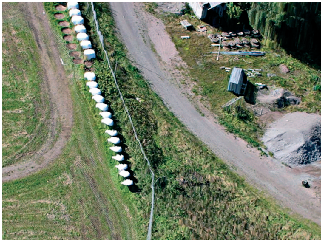
Kuva 3. UAV-kuvauksesta tuotetun 3D-pistepilven visualisointi, tarkkuus 2,5 cm:n maastopikseli. Kunkin maastopikselin korkeustieto on yhdistetty lennokin ottamaan väriilmakuvaan ja näin saatu kolmiulotteinen tietokanta jatkoanalyysijä ja mittauksia varten. Kuva: PIEnengineering Oy, Mikko Sippo.
