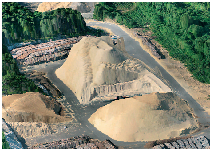
Kuva 8. Hakevarasto Ruotsissa lennökkikartoituksella tuotettuna kolmiulotteisena mallina, jonka avulla voidaan mitata varaston tilavuus ja arvioida sen energiasisältö. Kuva: PIEnengineering Oy, Mikko Sipponen.
