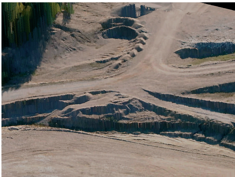
Kuva 7. Maa-ainesten ottoalue, josta laaditulle kolmiulotteisella mallilla voidaan monitoroida ottomääriä ja ottosyvyyksiä. Kuva: PIEnengineering Oy, Mikko Sippo.
