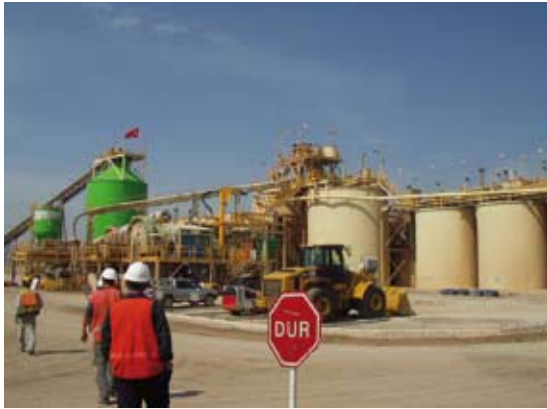
Kuva 5. Ovacikin kullan ja hopean rikastuslaitos jauhatusmyllyineen ja syanidiliuotustankkeineen. Kuva: Kari Kojonen. Figure 5. The milling and cyanide leaching tank gold processing plant in Ovacik. Photo by the author.
