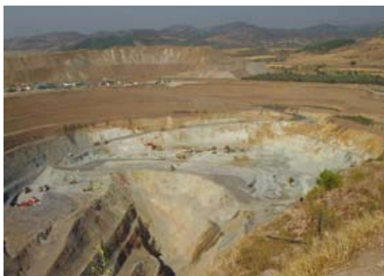
Kuva 4. Ovacikin avolouhos; kultapitoinen kvartsijuoni erottuu kuvassa ylhäällä ruskeana vyöhykkeenä louhoksessa olevien työkoneiden oikealla puolella. Kuva: Kari Kojonen.
