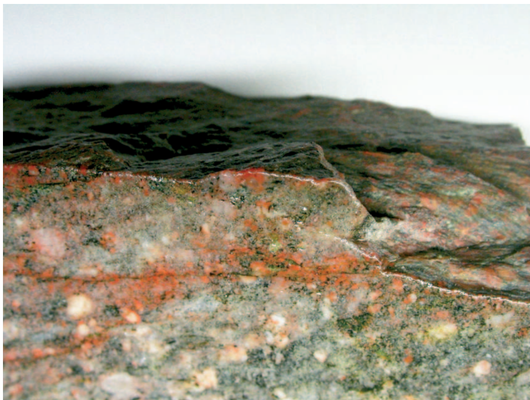
Kuva 3. Keurusselän pirstekartioiden pituussuuntaan sahattu leikkaus. Pirstekartiot ilmenevät hiertyneessä maasälpämetaporfyryssä punaisina hematitiin värjääminä hiertopintojen ryhminä, joita pitkin myöhempi rakoilu on edennyt. Kuva-alan leveys 3 cm. Löytöpaikka: Keuruu, Valkeajärven länsiranta. Kuva: Kari A. Kinnunen.
