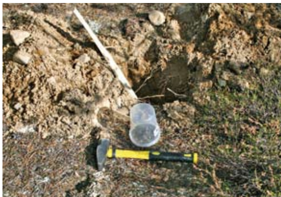
Kuva 3. Radontutkimuskuoppa, jonka syvyys on n. 50 cm ja leveys 20 cm. Kuva: Toni Eerola
