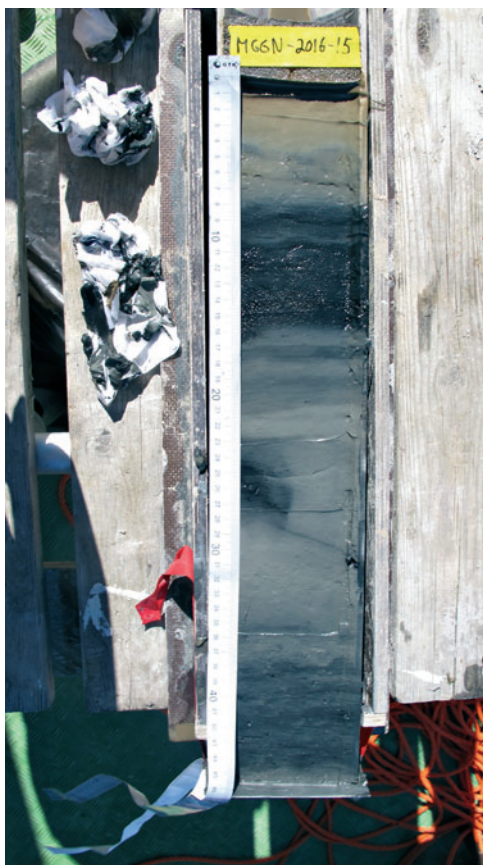
Köysimontusta nostettu sedimenttinäyte halkaistuna pöydällä. Näyte on kauttaaltaan pohjaeläinten kaivautumisjälkien kirjomaa, mikä kertoo vallitsevasta hyvästä happitilanteesta. Mustan värin vaihtelu kuvastaa rautamonosulfidien runsautta, joka on seurausta vaihtelusta eloperäisen aineksen määrässä sedimentissä sekä meriveden sulfaatin pelkistymisvyöhykkeen sijainnista.
