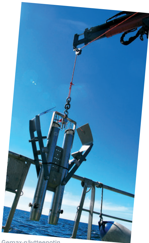
Gemax-näytteenotin köyteen solmittuna ja valmiina matkaan kohti syvyyksiä. Näytteenottimessa on kaksi näytesäiliötä, joihin kumpaakin tulee näyte samalla kertaa.
