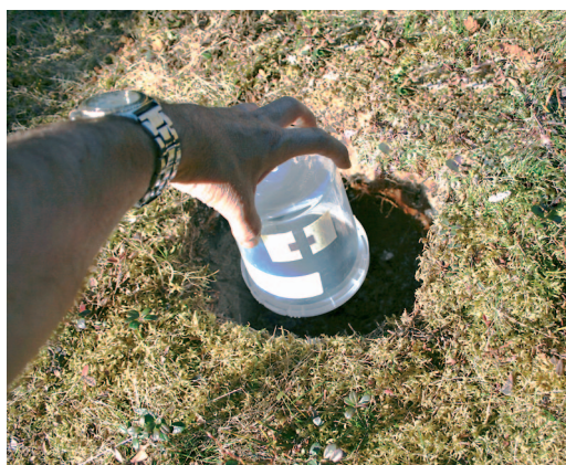
Kuva 2. Lapiolla kaivettu, 50 cm syvään ja 20 cm leveä radontutkimuskuoppa, johon asetetaan radonmittari. Se on muovikuppi, jonka sisäpuolelle on teipattu filmi, joka reagoi alfahiukkasiin. Kuva kirjoittajan.
