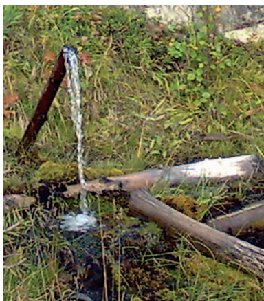
Kuva 3. Vettä vuotava, avoin kairausputki (n. 50 cm pitkä) Kouvervaarassa, Kuusamossa. Kuva kirjoittajan.
