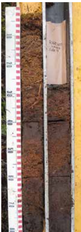
Kuva 2. Ilomantsin Rahesuo ojitamattoman ja ojitetun puolen turveprofiilien vertailu. Reunaosan eri puolilta kairatut näytteet on asetettu rinnakkain vaaituksella mitatun pinnan korkeuden mukaisesti. Ojitetun puolen pinta (oikeanpuoleinen näyte) oli 27 cm ojitamatonta alempana. Visuaalinen turvekerrosten rinnastus osoittaa, että alenema johtuu nimenomaan pintaturpeen häviämisestä (Pitkänen ym. 2013). Kuva: Heikki Simola.
