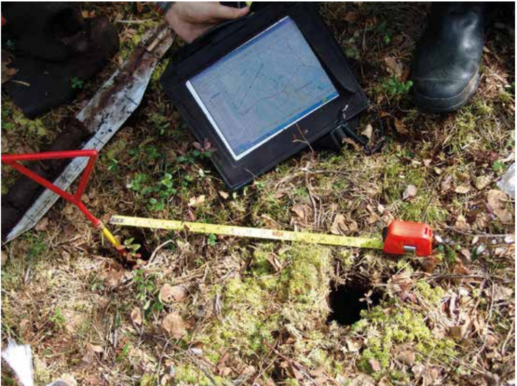
Kuva 1. GPS-paikannuksen tarkkuus osoittautui varsin hyväksi vanhoja GTK:n turvekairauspisteitä jäljitettäessä (Simola ym. 2012). Vuonna 2009 Pieksämäen Aumakankaansuolla löysimme jopa alkuperäiset, GTK:n 1980-luvun kairausreiät oman kairauspisteemme vierestä. Kuva: Heikki Simola.
