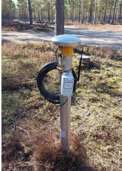
Kuva 2. Pohjaveden havaintoputkeen asennettu langattomalla yhteydellä toimiva CTD-pohjavesiloggeri, jolla seurataan pohjaveden pintaa, lämpötilaa ja sähkönjohtavuutta. Kuva: Olli Sallasmaa.
