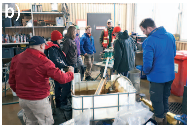
Kuva 3. Raskasmineraalinäytteiden konsentroidintia Agnico Eaglen Pakatin näytteenkäsittelytiloissa a) Jorma Valkaman operoimalla spiraalirikastimella eli ns. kultakoiralla ja b) Teuvo Keränen käyttämällä Knelson konsentraattorilla. Kuva: Pertti Sarala
