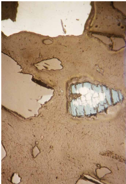
Kuva 5. Polarisaaatimikroskooppikuva heijastavassa valossa näytteestä 4. Rakeen vaaleanharmaa keskiosa magneetikiiusia, sininen reunaosa kovelliittia. Kuva: Vesa Peuraniemi.
