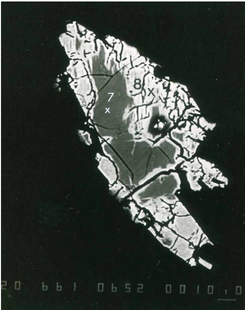
Kuva 3. Pyyhkäisyelektronimikroskooppikuva näytteestä 2. Rakeen keskiosa (analyysipiste 7) kuparikiisua, reunaosa (analyysipiste 8) kovelliittia. Kuva: Vesa Peuraniemi.
