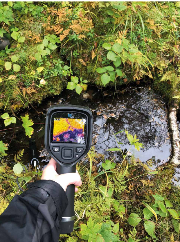
Kuva 4. FLIR-lämpökameran avulla määritettiin pohjaveden purkautumiskohtia pintaveteen. Kuva: Rebekka Salmi.
