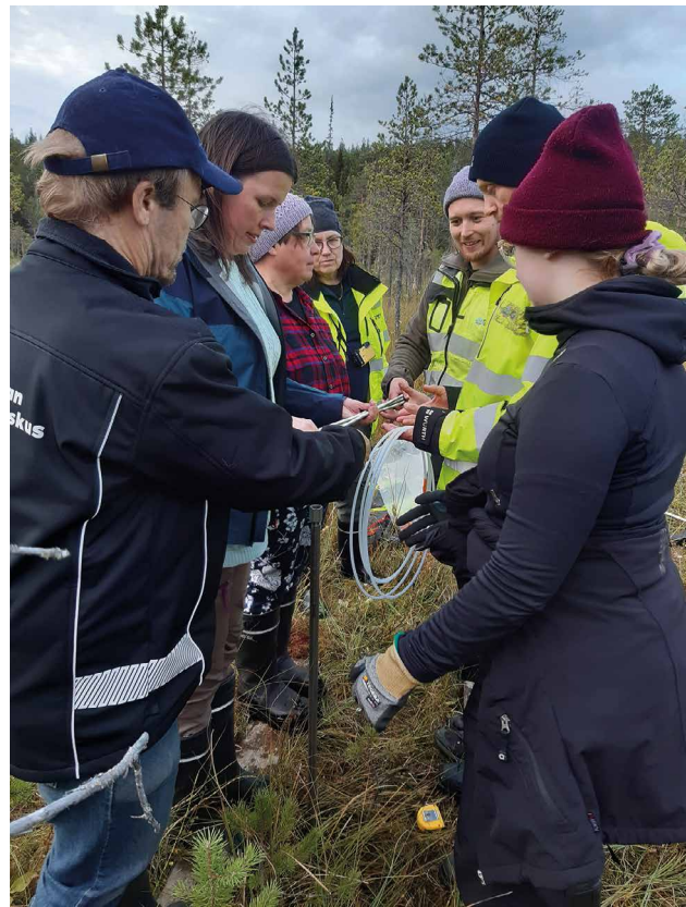
Kuva 5. Vesinäytteenottoa minipietsometrillä Puukkosuolla. Kuva: Niina Kuosmanen.
