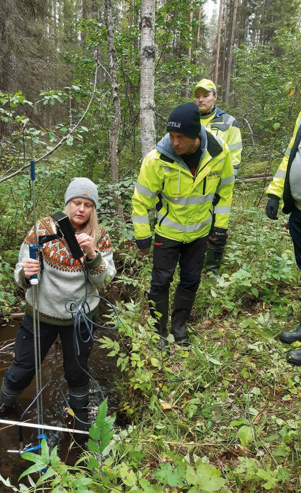
Kuva 6. Virtaamamittausta FlowTracker-laitteella Rytipurossa. Kuva: Niina Kuosmanen.
