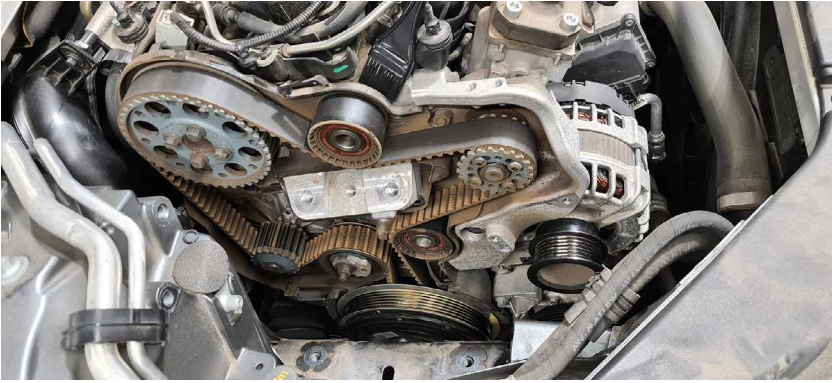
Kuva 1. Auton jakopää pääkauk-punkiseudulle tyypillisessä vähäpölyisessä autossa. Kuva: Mika Räisänen.
