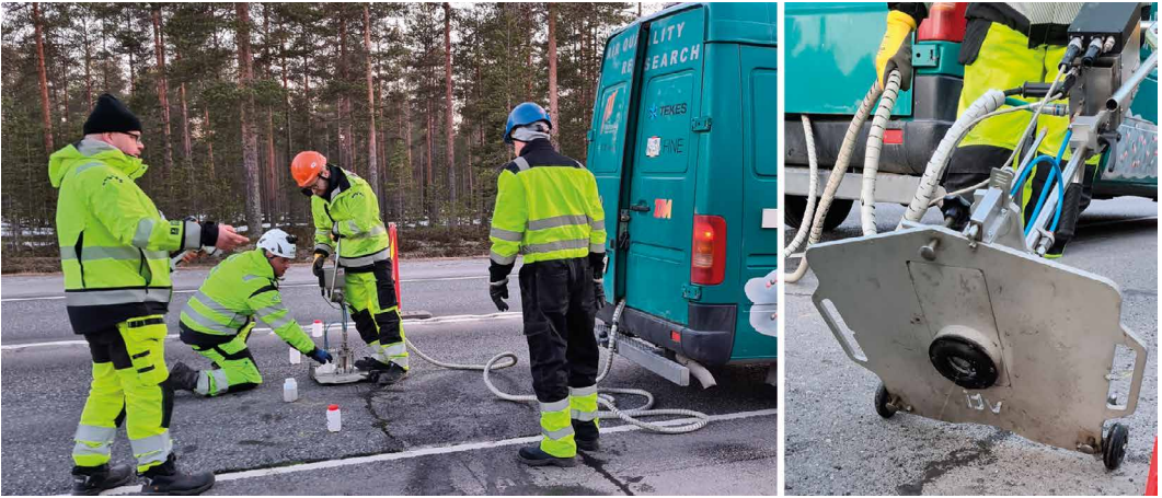
Kuva 4. WDS-näytteenottoa (wet dust sampler), jossa kerätään tienpinnalle kertynyttä pölyä painehuuhtelun avulla. Kuvat: Mika Räisänen.
