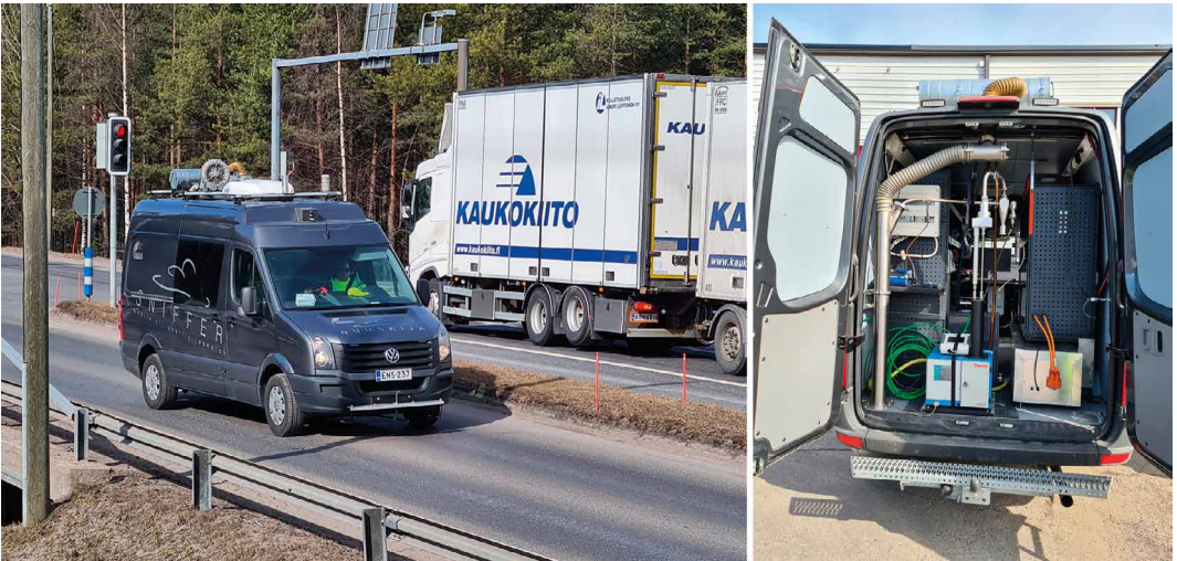
Kuva 5. Metropolia Ammattikorkeakoulun Nuuskija-auto on liikennepäästöjä ja katupölypitoisuuksia mittaava mobiili mittaustalio. Kuvat: Mika Räisänen.
