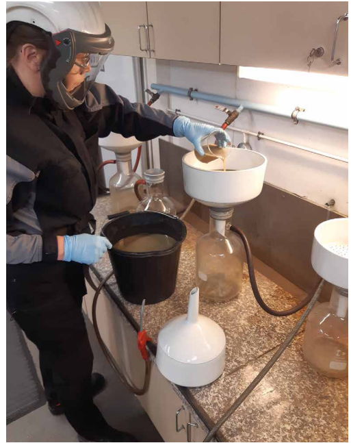
Kuva 9. Testipölyjen valmistusta GTK:n Prosessilaboratoriossa Outokummussa. Kuva: Akseli Torppa.
