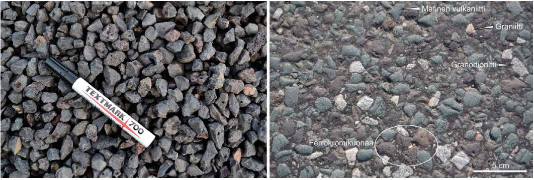
Kuva 7. Asfaltin kiviaineksena käytettyä 11–16 mm fraktiokoon ferrokromikuonaa eli OKTO-mursketta. Kuonamurskeen kappaleilla on terävät reunat ja niissä on reikiä/huokosia (vasen kuva) – joista se on helppo tunnistaa. Oulun Lentokentätien asfaltin kiviaineksina on käytetty ferrokromikuonan lisäksi mafista vulkaniittia, granodioriittia ja graniittia (oikea kuva). Kuvat: Mika Räisänen.
