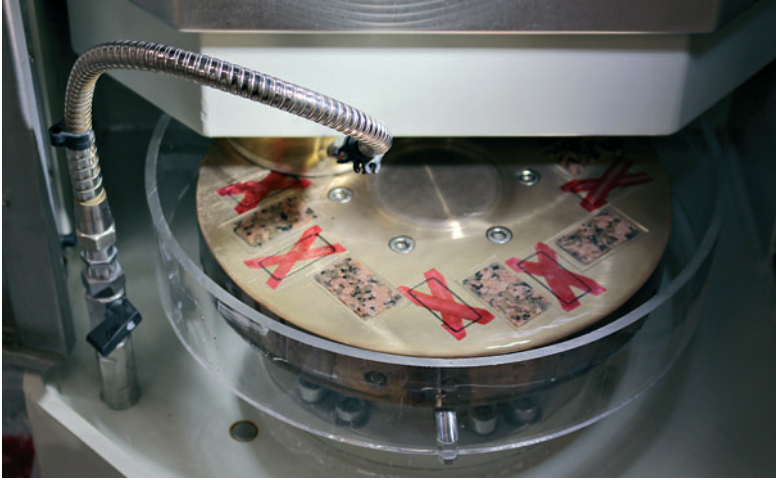
Kuva 2. GRN16 tasohiomakoneen pyörivälle vakuumpöydälle mahtuu 16 kpl 28 × 48 mm näytteitä.
