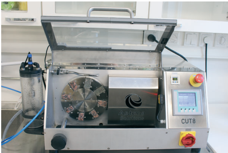
Kuva 3. CUT8 katkaisusahan vakuumpöydälle mahtuu 8 kpl 28 × 48 mm näytteitä. Pyörivän pöydän ansiosta sahaus kohdistuu aina vain yhden hiepalan yhteen kulmaan. Koska sahanterään kohdistuu sahauksessa vain pieni voima, pysyy ohut sahanterä sahauksen aikana suorassa.
