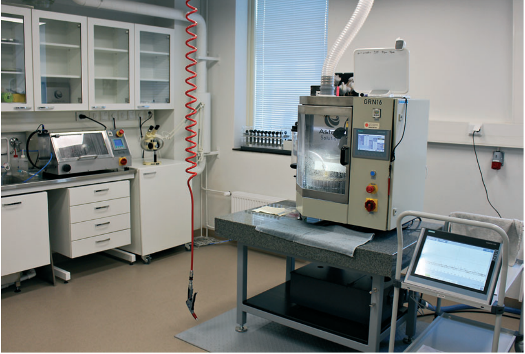
Kuva 1. Turun Geotalon hielaboratorion ohuthielaitteet (Aster GRN16, CUT8 ja GLU20).
