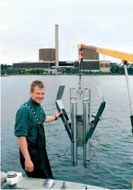
Kuva 1. GEMINI-näytteenotin (Kuva: STUK / E.Illus). Figure 1. Sediment sampling with a GEMINI sampler (Photo: STUK / E.Illus).
