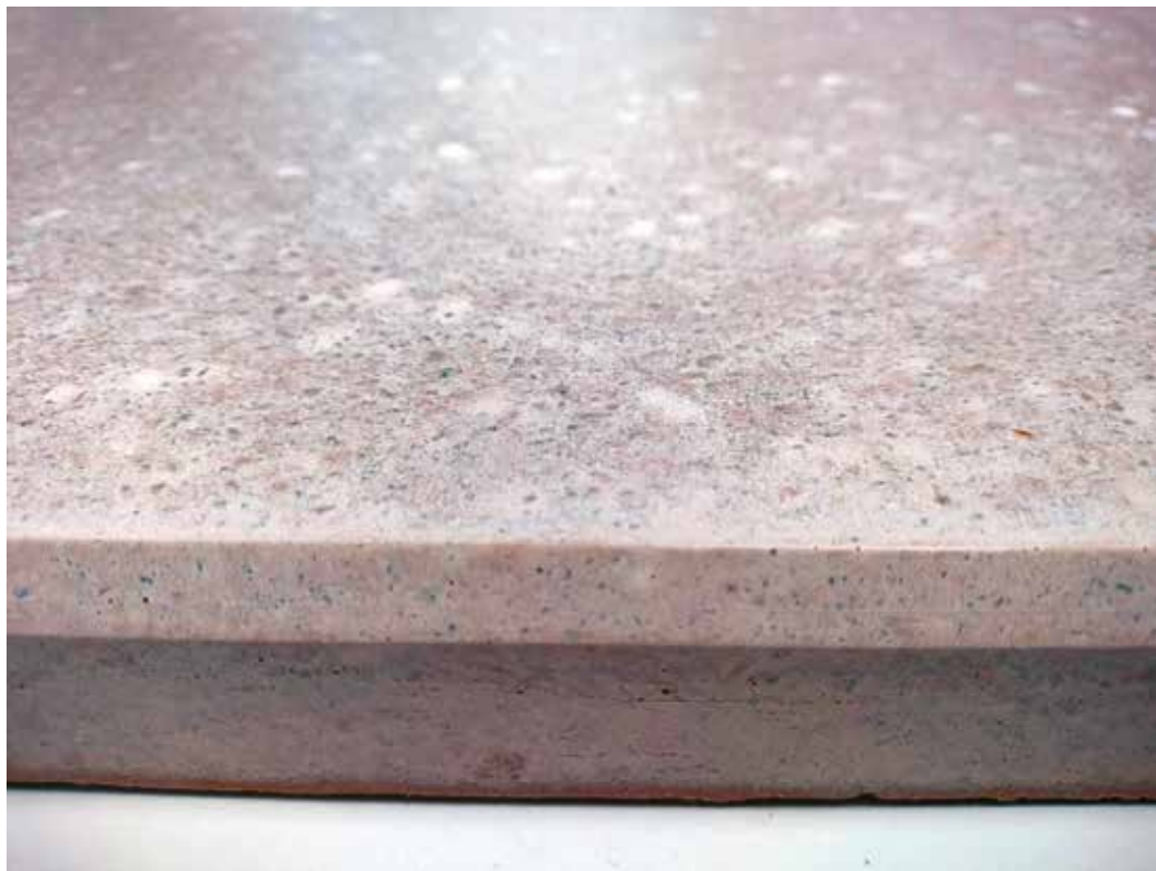
Kuva 1. Keko Geopolymeerit Oy:n valmistama pöytälevy, jossa on käytetty rikastushiekkaa ja materiaali on kovetettu geopolymeeritekniikalla. Kuva: Jouni Rissanen.
