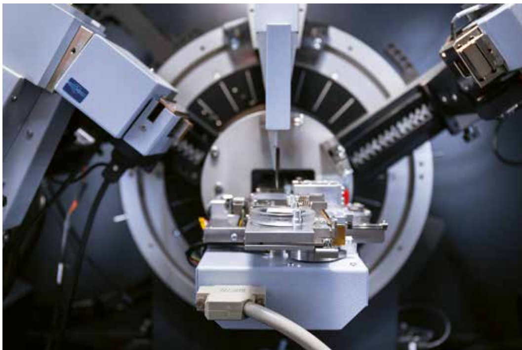
Kuva 3. Röntgendiffraktiolaitteisto. Kuva: Geologian tutkimuskeskus / Matti Immonen.
