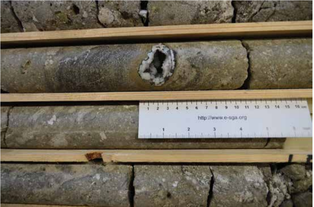
Kuva 1. Lappajärven törmäyssulapitoinen breksia (sueviitti), jossa on mineraaleilla täyttyneitä onkaloita. Tämä kairasydännäyte oli mukana tutkimuksessa. Kuva: Satu Hietala, GTK.
