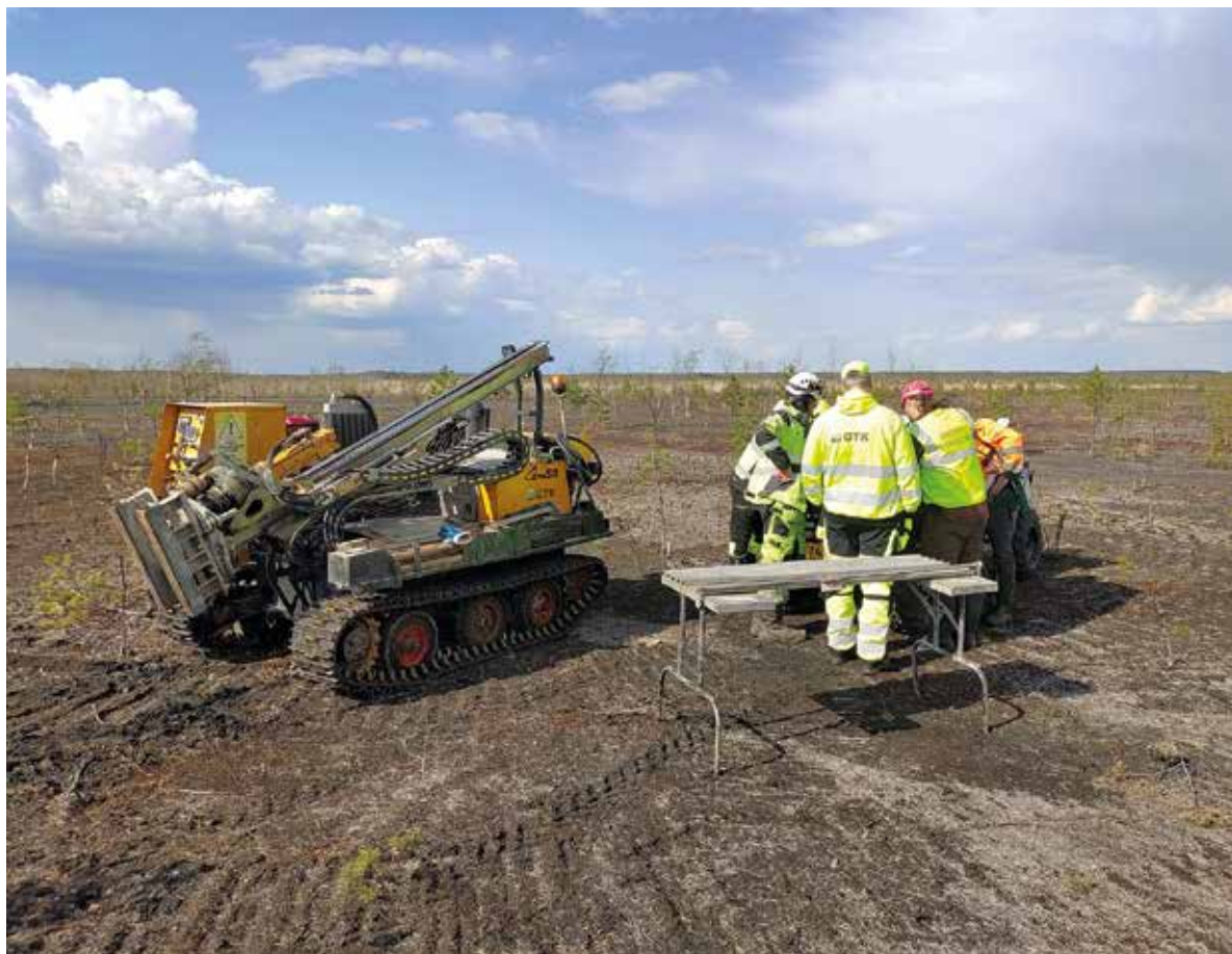
Kuva 3. Näytteenotto käynnistymässä Otanmäen rikastushiekka-alueella osana FutuRaM-projektia. Näytteenotossa käytettiin GTK:n GM50-kairakonetta. Uusia reikiä kairattiin 33 kappaletta, joiden keskisyyvyys oli 6,9 metriä. Kuva: Teemu Karlsson.
