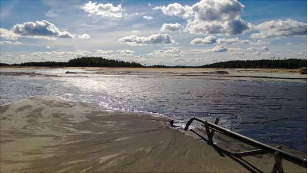
Kuva 1. Vaahdotusprosessissa syntynyt rikastushiekka pumpataan rikastushiekka-alueille. Kuva: Teemu Karlsson.
