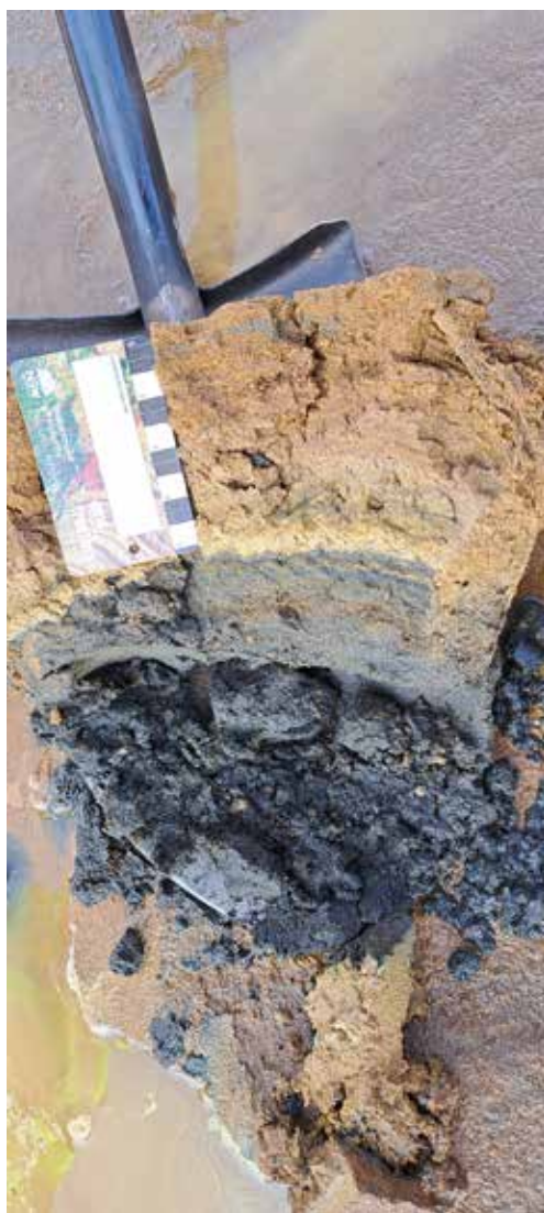
Kuva 3. Orijärven suljetulta rikastushiekka-alueelta otettiin lapionäytteitä rikastustutkimuksia varten kesällä 2025. Pintakerros on hapettunut ruskeaksi. Kuva: Mari Kivinen.
