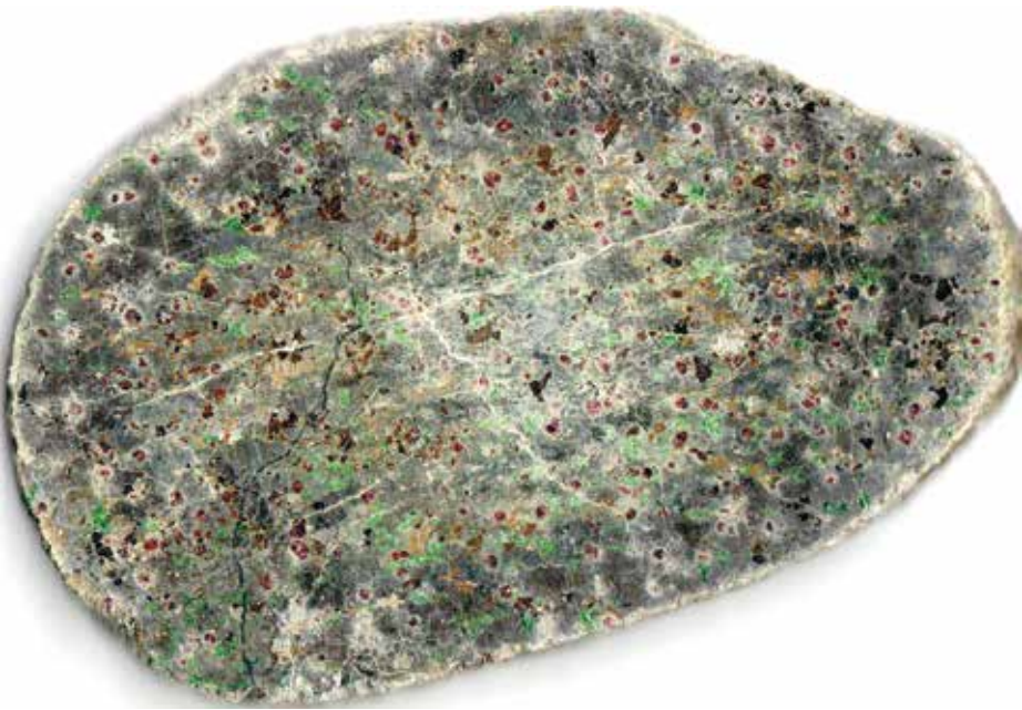
Kuva 4. Lahtojoen esiintymästä löytyi myös vaipan kivilajeja ksenoliitteina. Kuvassa oleva leike on tehty noin 30 cm kokoisesta ksenoliitista. Näytteessä on nähtävissä mm. vihreitä uvaroviittigranaatteja, punertavia pyrooppigranaatteja sekä mustia pikroilmeniittirakeita, jotka kaikki ovat tyypillisiä vaipan mineraaleja ja kimberliittien etsinnässä käytettyjä indikaattorimineraaleja. Kuva: Heikki Papunen.
