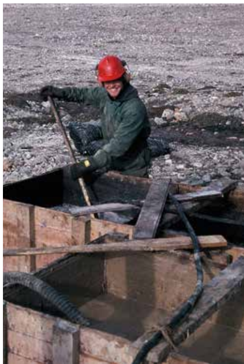
Kuva 4. Jäänestoaineen ( \text{CaCl}_2 ) liuottamista kiertätyskaukaloissa. Kuva: Jorma Mikkosen arkisto.
