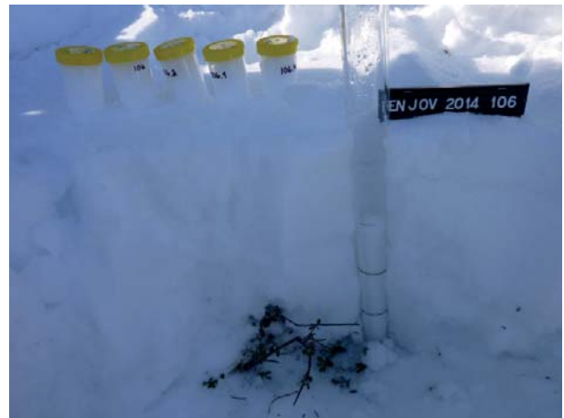
Kuva 4. Luminäytteenottoa käyttäen akryyliputkea. Näytteet kerätään lumipeitteen pohjaosasta 10–20 cm syvyydeltä maanpinnasta ylöspäin. Kuva: Jorma Valkama, Geologian tutkimuskeskus.
