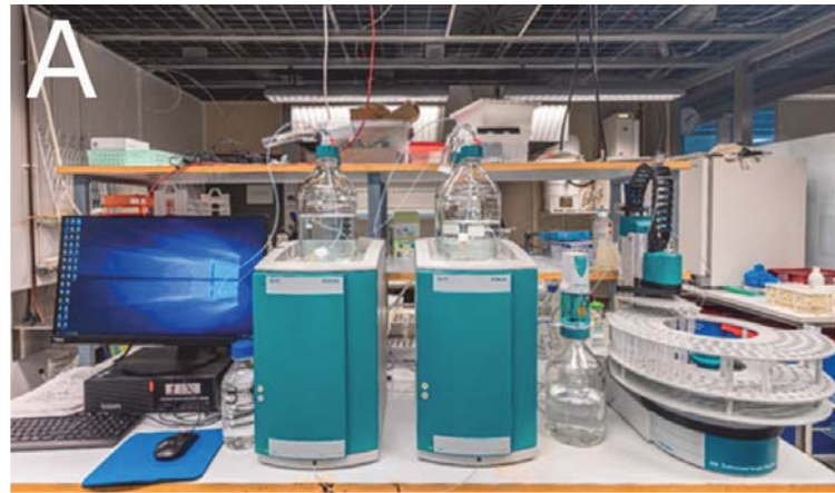
Kuva 2. HelLabs-laboratorion laitteistoja. Metrohm ECO -tandem-ionikromatografi, jota käytetään veden pääkomponenttianalyysissä (A) sekä Agilent 7900 -ICP-MS-laitteisto ja siihen yhdistetty koherentti 193 nm laser (GeoLas MV) kiinteän aineen LA-ICP-MS-mikroanalyyysiin (B).
