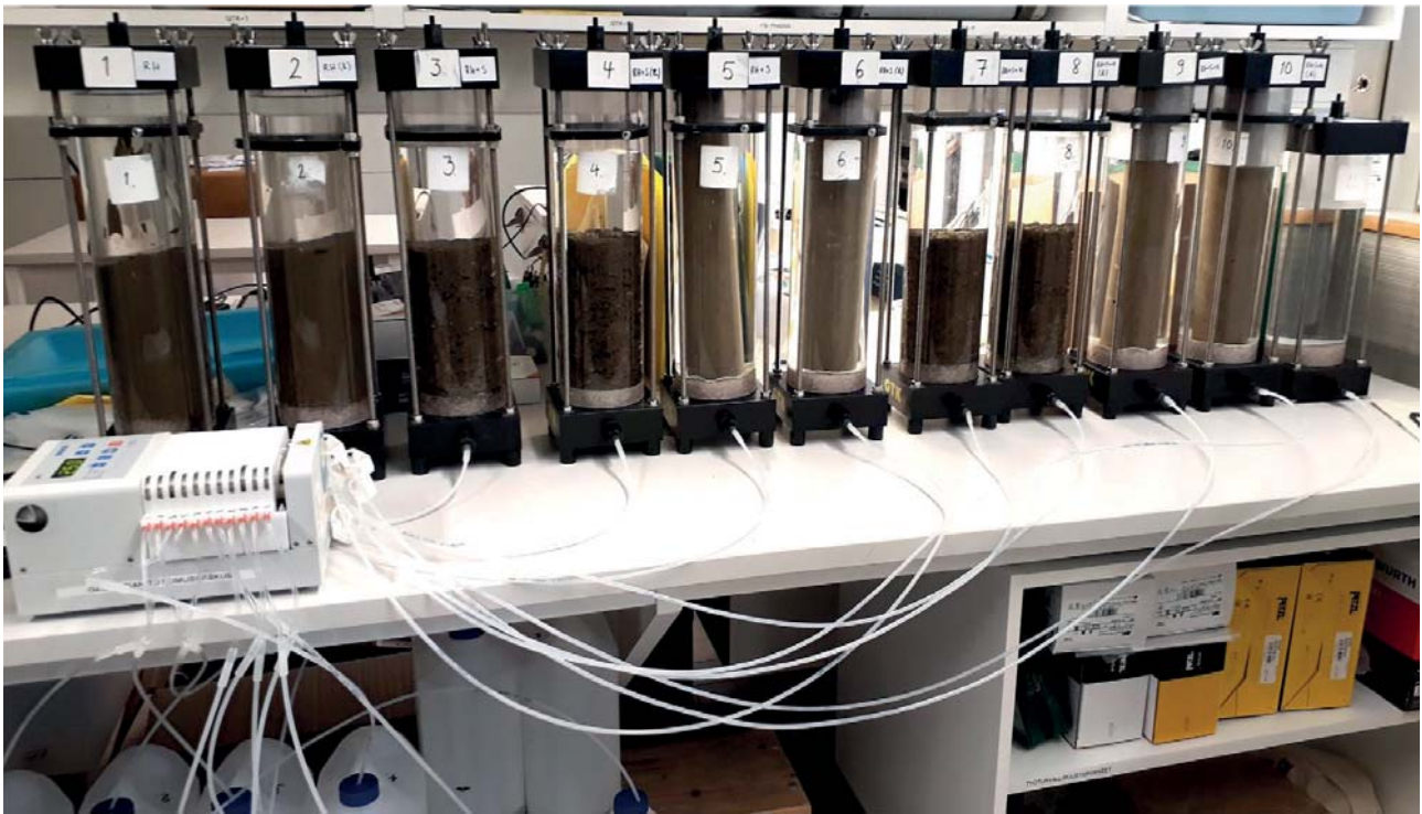
Kuva 1. Kovettuvien kaivostäyttömateriaalien pitkäaikaistutkimuksen koejärjestely. Kahdessa ensimmäisessä kolonnissa on pelkkää rikastushiekkaa ja lopuissa sementin ja kuonan avulla kovetettuja rikastushiekkaa sisältäviä kappaleita murskattuina ja kokonaisina. Tutkimuksessa materiaaleja käsiteltiin kaivosvedellä yhdeksän kuukauden ajan ja saadut tulokset julkaistaan myöhemmin. Kuva: Soili Solismaa.
