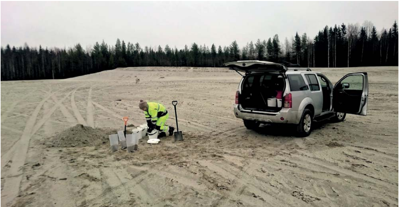
Kuva 2. Rikastushiekan hyötykäyttötutkimus lähtee liikkeelle tutkimuksen suunnittelusta ja näytteenotosta. Kuvassa otetaan rikastushiekanäytteitä Mätäsvaaran suljetun molybdeenikaivoksen rikastushiekkalueelta. Kuva: Teemu Karlsson.
