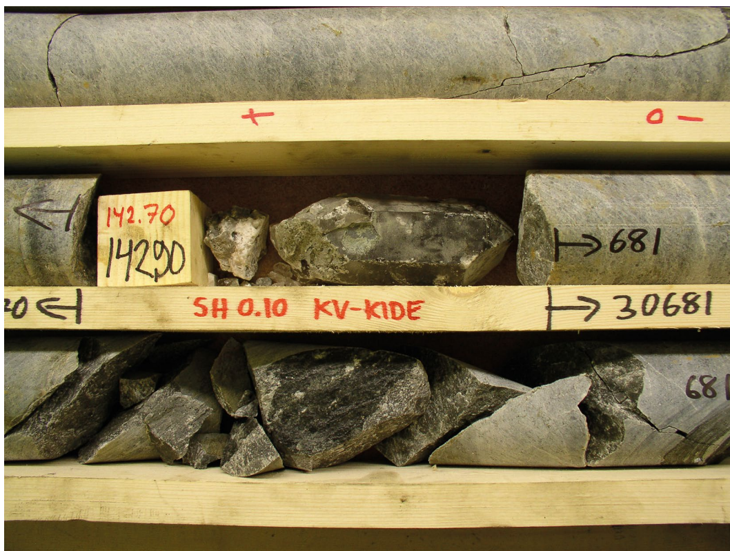
Kuva 1. Kvartsikide kairasydänreiässä T-553 syvyydellä 142,80 m. Kuva kirjoittajan.
