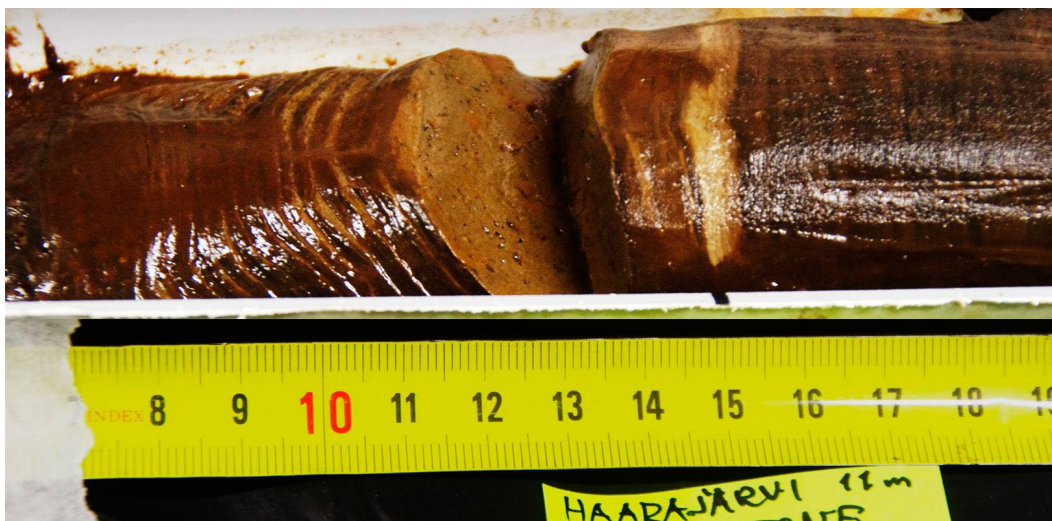
Kuva 3. Kairanäyte Haara-järven pääaltaan syvänteestä (syvyys 11 m). Sedimentin muutoskohta 15 cm:n tasolla (noin 5 mm paksu savikerros) vastaa pohjoisen syvänteen paksua silttikerrosta 57–61 cm:n tasolla. Näyte on otettu Kajak-putkinoutimella, ja tuoreena näyteputkesta u-muotoiseen kouruun työnnetty näyte on luontaisesti siivuttunut muutoskohdan jälkeen kerrostuneiden vuosilustojen kevättulvaa edustavien savikerrosten kohdilta. Sedimentin pehmeä, lähes hyytelömäinen rakenne (suuri vesipitoisuus) on näytteessä hyvin havaittavissa. Muutoskohtaa edeltävät vuosilustot (kuvassa oikealla) ovat varsin säännöllisiä, 2–3 mm:n paksuisia, eikä niissä ole harmaata savikerrosta erotettavissa.
