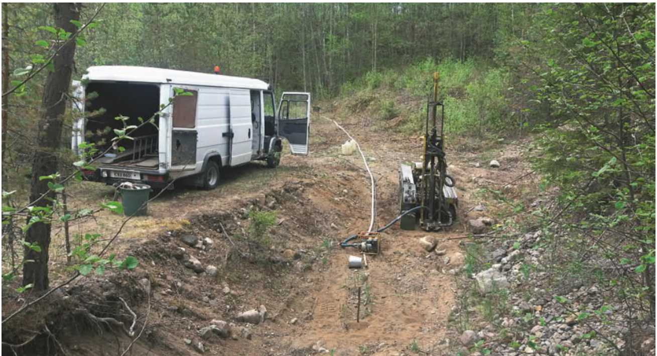
Kuva 1. Kairaus- ja pumppauskalusto Jyväskylän Korpilahdella Reinanpohjassa pisteellä 1B 30.5.2017. Ns32-imuputken siiviläosa on monitoimikairalla lyöty 5–7 metriin maanpinnasta, putki huuhdeltu ja pumppaus aloitettu. Sininen on imuletku ja valkoinen poistoletku; pumppaustuotto 130 l/min. Kuva: Ossi Alho
