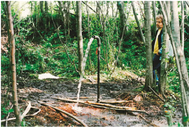
Kuva 4. Artesinen Metsäsian lähde Saarijärven Peltokylällä 6.8.1987 (ks. Mäkelä ja Illmer 1993). Hyvälaatuista pohjavettä purkautuu omalla paineellaan 83 l/min Ns32-teräsputkesta, jonka siiviläosa on 19–21 m mp:sta. Vedentuloa seuraa Tauno Savela. Kuva: Jorma Mäkelä
