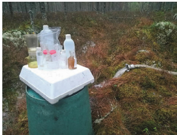
Kuva 2. Näytteenotto suoritettu kerrospumppauspisteellä 5 Multian Köpinkankaalla 12.11.2018. Happipullon (oik.) ruskea väri kertoo pohjaveden hyvästä happitilanteesta. Siiviläsyvyys 5–7 m mp:sta, pumppaustuotto 177 l/min. Kuva: Ossi Alho
