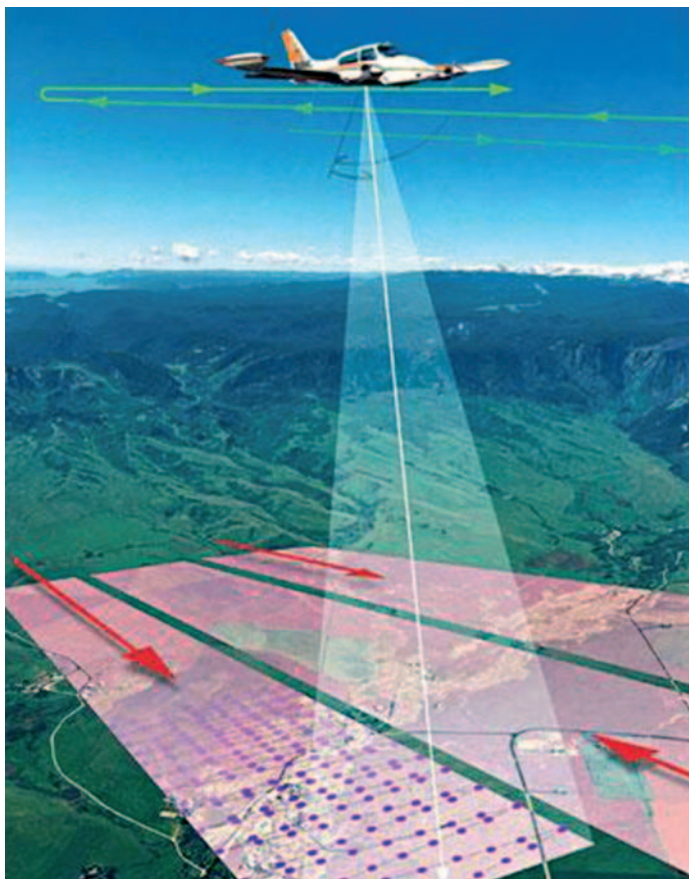
Kuva 1. LIDAR-laserkeilauksen periaate. Mittaus tapahtuu noin 2 km korkeudesta.
