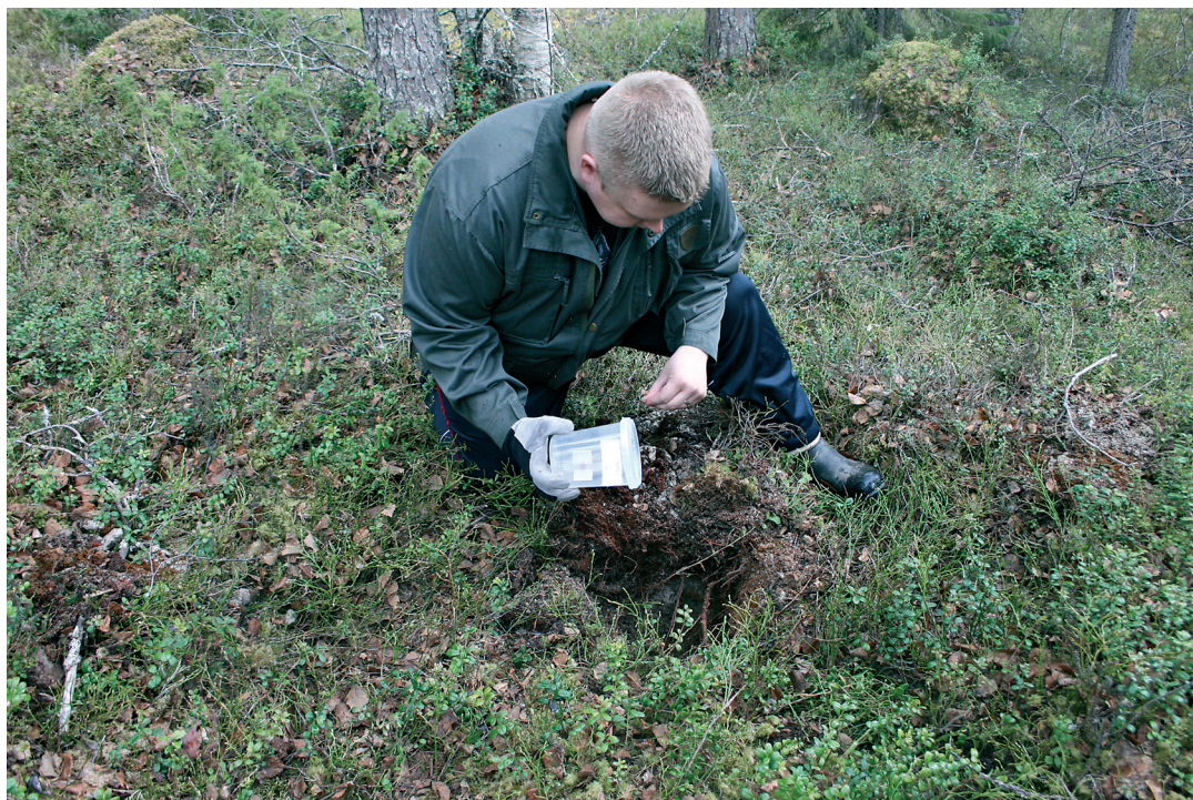
Kuva 4. Radontutkimuskuppi asetetaan suu alaspäin n. 50 cm syvään ja 20 cm leveään kuoppaan. Kupin kyljen sisäpuolella on radonkaasuun reagoiva filmi (kuva kirjoittajan).
