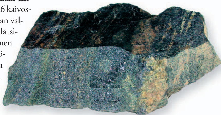
Kuva 1. Esimerkki Bölen kaivoksen kuopan 2 sivukivivallista poimitusta malmista. Tasaiset ylä- ja alapinnat ovat hiertopintoja, joita pitkin malmi on ollut helpposti irroitettavissa. Musta kiiltävä mineraali on magnetiittia, vihertävät ja ruskeat karsimineraaleja. Hiertopintojen kiilto aiheutuu kloriitista. Kappaleen läpimitta on 7 cm. (Kinnunen 2008c.) Kuva: Kari A. Kinnunen/GTK.
