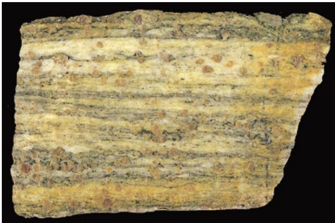
Kuva 5.15. Raitainen, granaattipitoinen granuliitti Inarista. Näytteen sahattu pinta on n. 6 x 9 cm. Näyte Helsingin yliopiston kivimuseon kokoelmista. Kuva Helena Saarinen.
