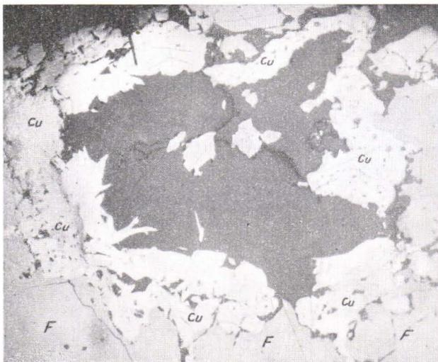
Abb. 2. Gudmundit (weiss) in mehr oder minder stengeligen Aggregaten an den Rändern einer Quarzpartie (dunkelgrau). Cu = Kupferkies, F = Fahlerz. Vergr. 22  $\times$ . Photo V. Räsänen.
