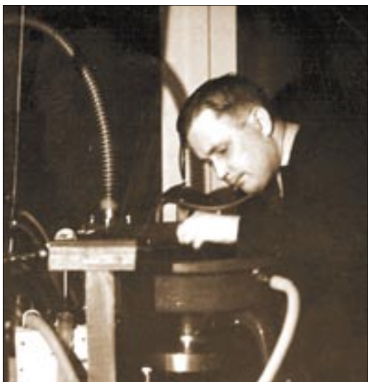
Kuva 1.6. Laittegeologi Th. G. Sahama rakentamassa röntgenspektrografia Helsingin yliopiston geokemian laboratorioon v. 1938. Tällä laitteella tehtiin aikanaan kansainvälisesti huipputarkkoja geokemiallisia hivenalkuainemääryksiä.
