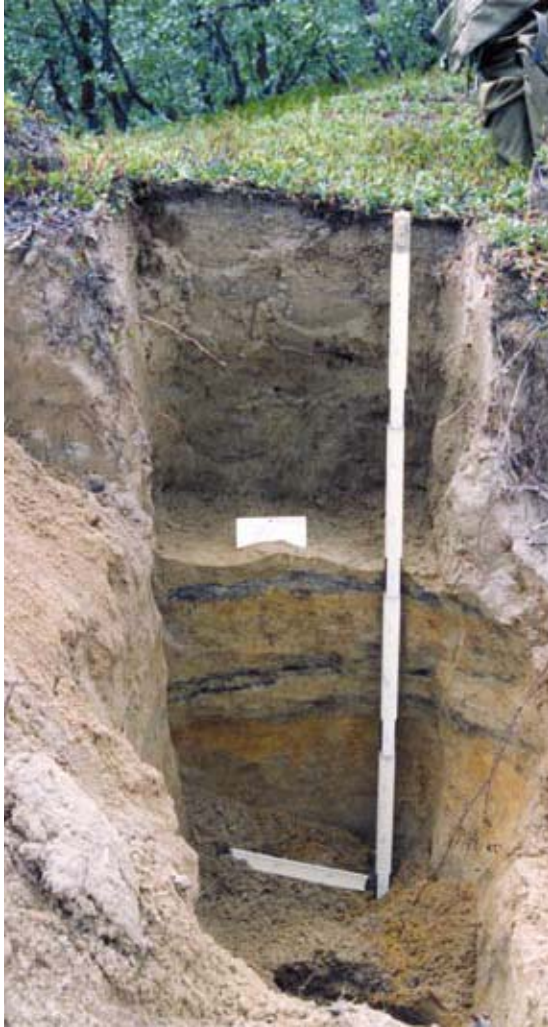
Kuva 4. Näytteenotto metsäpalohorisonttien radiohiili-ajoituksia varten tehtiin dyynileikkaukseen kaivetuilta ”pöydiltä”. Kuva kirjoittajan.
