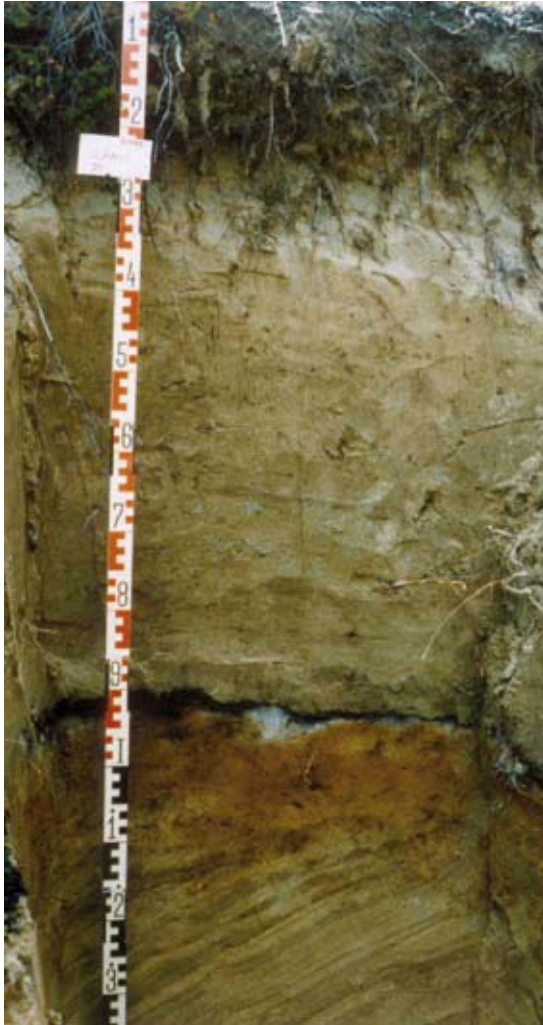
Kuva 3. Dyynileikkaus 51 Ijävrellä. Huomaa metsäpalo-horisontti ja sen alla oleva podsol-maannos 90–95 cm:n syvyydessä. Radiohiiliajoitus antoi paikalla kasvaneen metsän iäksi 1100 kalibroitua radiohiilivuotta. Kuva kirjoittajan.
