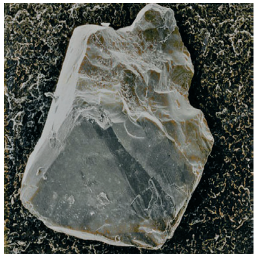
Kuva 9. Moreenin raskasmineraalirikasteen gahniiittirakeen alaosassa kuutiollista kidemuotoa, Hämeenlinna. SEM-kuva.
